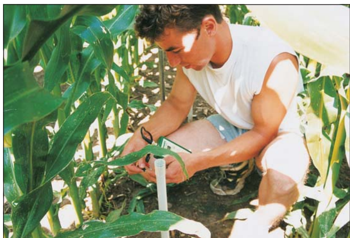
Le relevé d'une sonde tensiométrique dans un champ de maïs.
