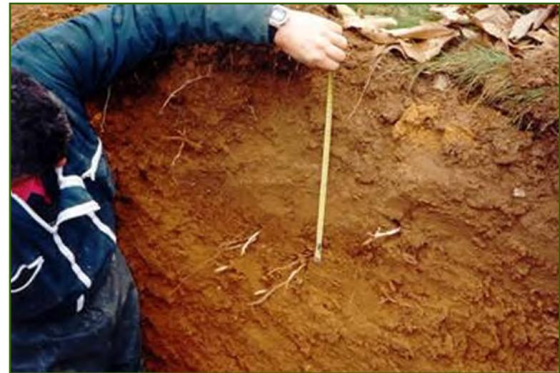
**Positionnement de 3 paires de sondes Watermark dans l'enracinement, à 25 et 50 cm de profondeur observation en permanence la disponibilité de l'eau du sol sur 3 zones irriguées au microjet.**
