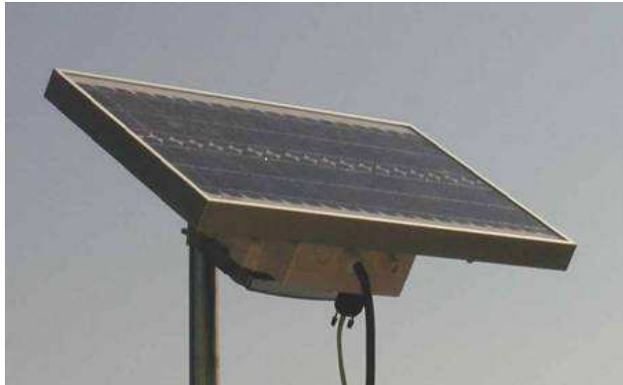
Panneau solaire, batterie, modem GPRS
