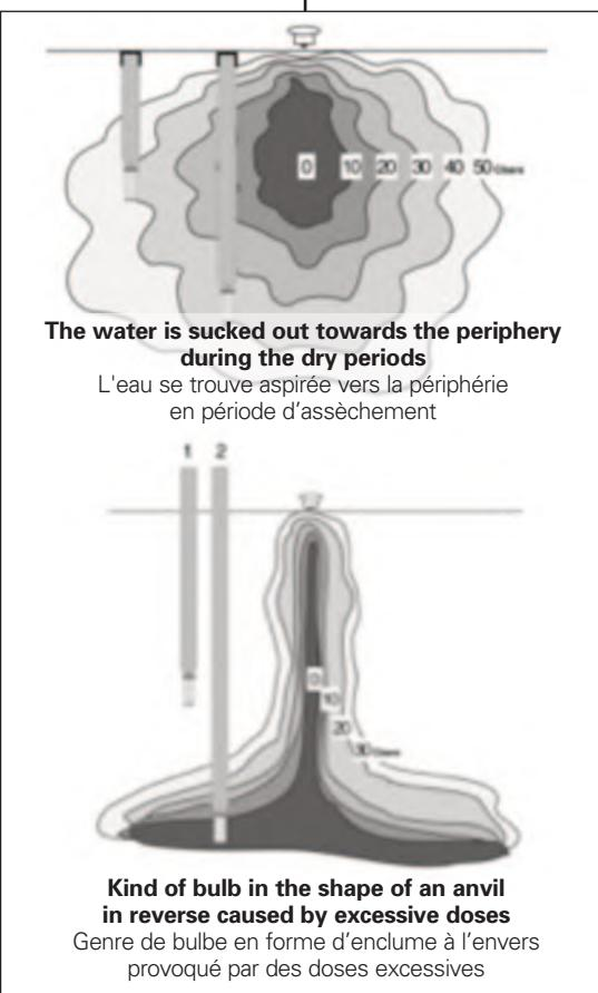
L'autre condition : que la pompe soit amorcée, c'est-à-dire que le sol ne soit pas trop sec. La pompe-sol fonctionne donc sur une plage bien définie, selon une courbe débit / pression précise, notion que les hydrauliciens connaissent bien. Les sondes tensiométriques sont des manomètres (précisément des vacuomètres) piqués à plusieurs endroits stratégiques de la pompe-sol dans le gradient de tension de plusieurs bulbes goutte-à-goutte.
